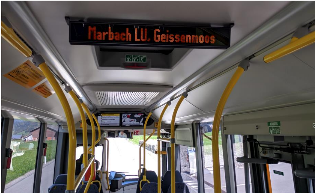
Figure 216: solution de CarPostal avec des affichages supplémentaires afin de respecter la taille minimale des caractères
